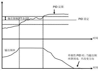
图 7-55-A 单极性 PID 控制方式
