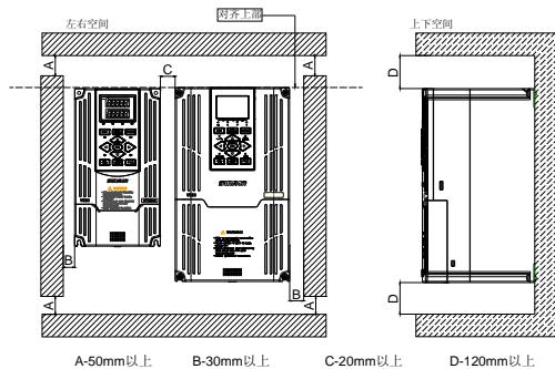
图 3-3 两台变频器（4.0KW 以上）左右安装尺寸
