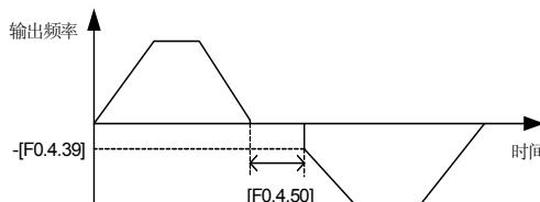
图 7-22 起动频率正反转切换示意图
