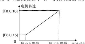
图 7-62 转速反馈值和电机转速对应关系图
