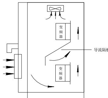
图 3-2 两台变频器上下安装间隔
