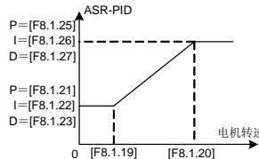
图 7-63-B 双 PID 参数 (连续切换)
