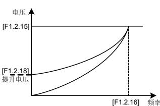
图 7-27-A 降转矩曲线转矩提升示意图
