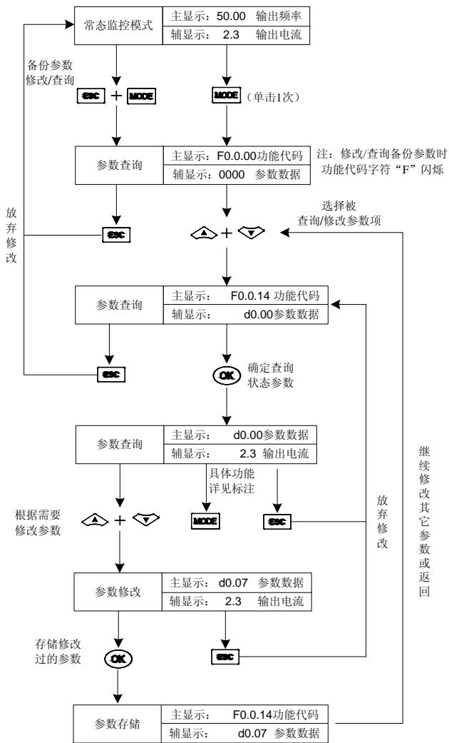
图 5-2 参数查询与修改示意图
