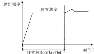
图 7-57 闭环预置频率运行示意图
