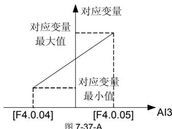
AI3 模拟输入与对应变量示意图(单极性)
