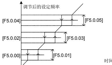
图 7-40 跳跃频率输出示意图
