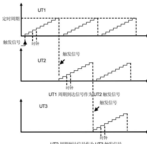
图 7-41-E 定时器 (UT1、UT2、UT3) 的触发串接功能
