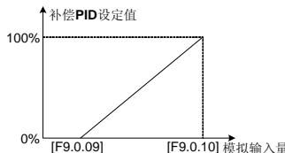
图 7-65 补偿 PID 设定值定义示意图
