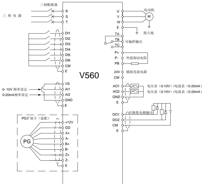
图 4-3 V560 系列变频器基本接线图
