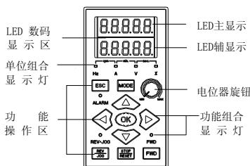
图 12-7-C 双行 LED 电位器小面板
