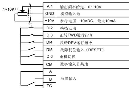
图 7-4 机床主轴驱动宏 AI1 设定接线图
