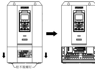
图 3-5 钣金盖板的拆卸安装示意图
