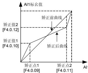
图 7-38 模拟输入 AI1 曲线
