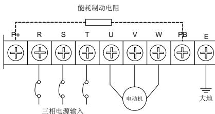
**III类主回路端子** 适用机型: V560-4T0055~V560-4T0110
