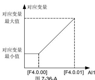
AI1 模拟输入与对应变量示意图 (单极性)
