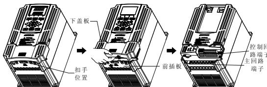
图 3-4 塑壳盖板的拆卸安装示意图
