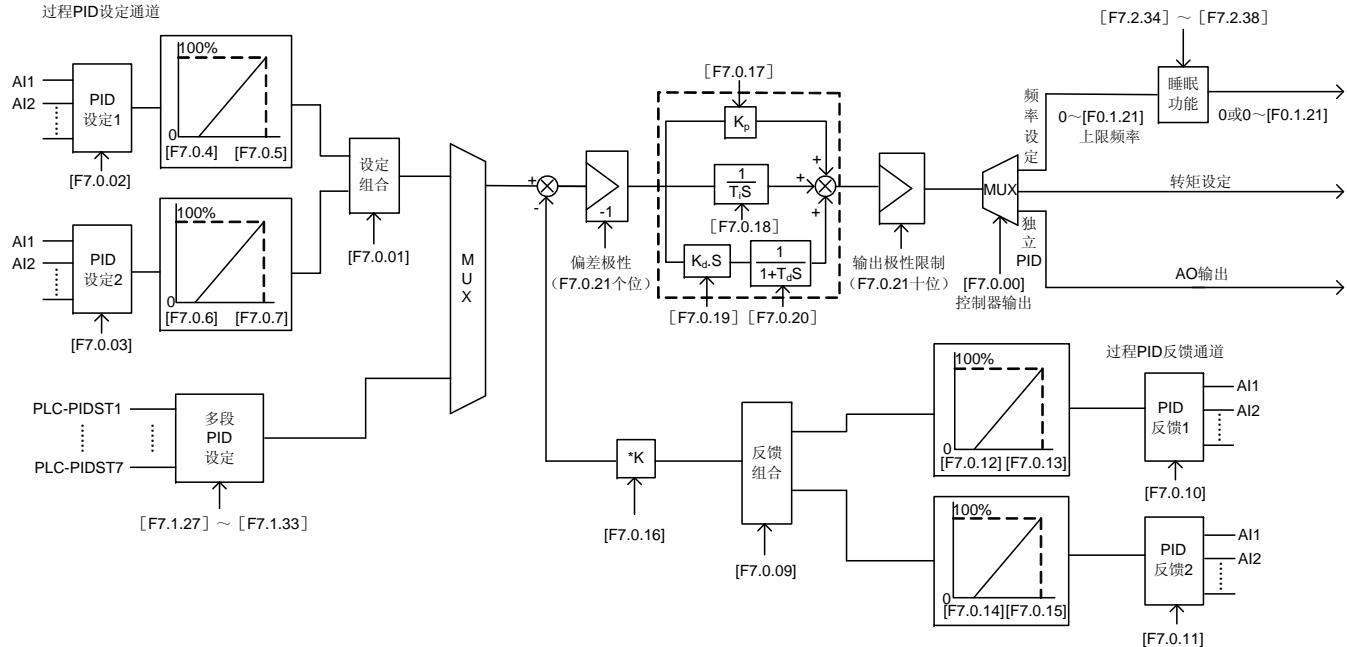
图 7-51 过程 PID 控制原理框图
