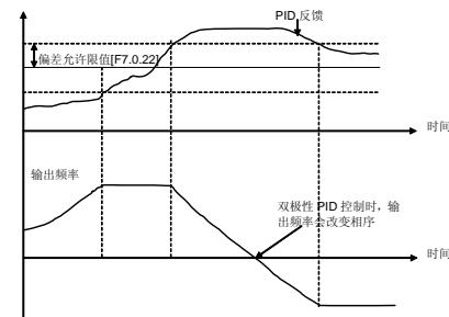
图 7-55-B 双极性 PID 控制方式
