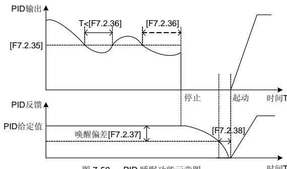
图 7-59 PID 睡眠功能示意图
