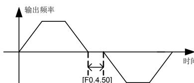
图 7-21 正反转过渡死区示意图
