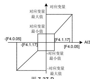
AI3 模拟输入与对应变量示意图(双极性)
