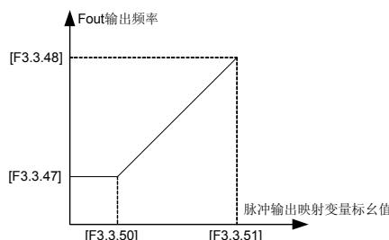
图 7-35 脉冲输出 Fout 特性曲
