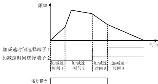
图 7-25 加、减速时间的外部端子选择方式
