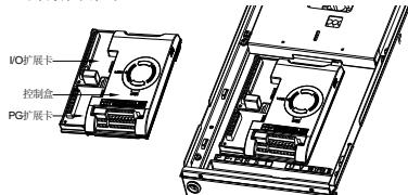
图 3-6 扩展卡的拆卸安装示意图
