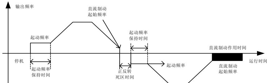
图 7-20 停机直流制动示意图
