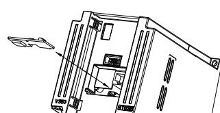
图 3-7-B II 类功能板的安装拆卸示意图
