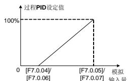
图 7-52 过程 PID 设定值示意图
